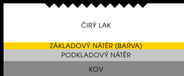
PŘÍPADNĚ OBROUŠENÁ VADA
